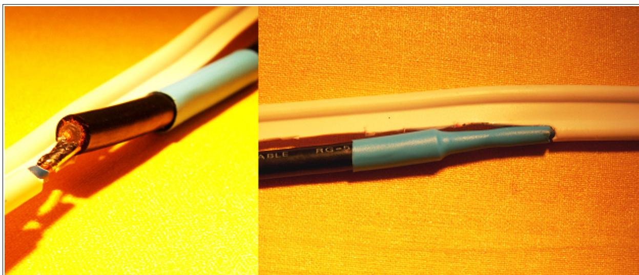
7. ábra – A leválasztó csonek alsó vége forrasztva és zsugoresővel ellátva
